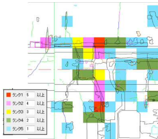
図3 ヒートマップ（はく落要注意箇所）
