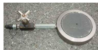
写真-3 汎用的なフラットジャッキ（厚さ 31mm）
