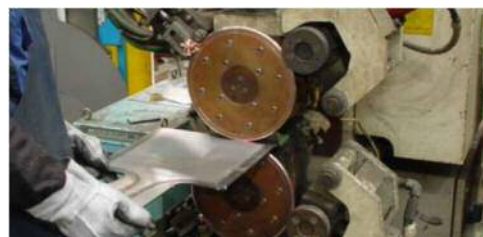
写真-4 シーム溶接状況
