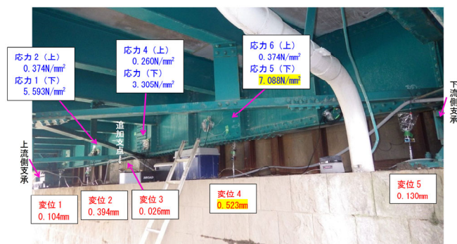
図-6 A2 橋台 変位・ひずみ計測点設置状況と最大値
