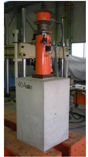
写真-1 引抜試験
