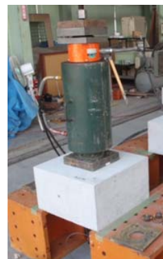
写真-4 引抜試験
