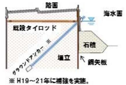
図-1 鮫洲埋立部の護岸構造
