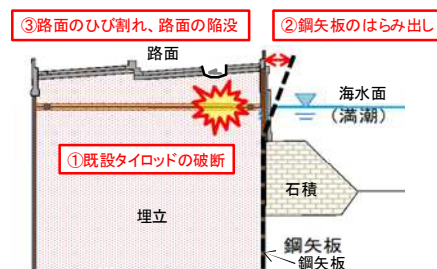
写真-2 鮫洲埋立部損傷状況
