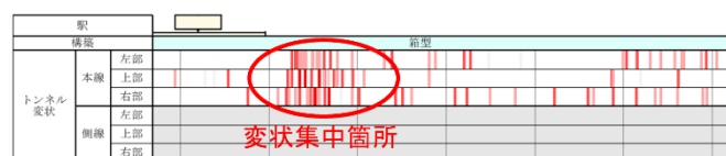
図2 可視化ツールによる変状分布状況の一例
