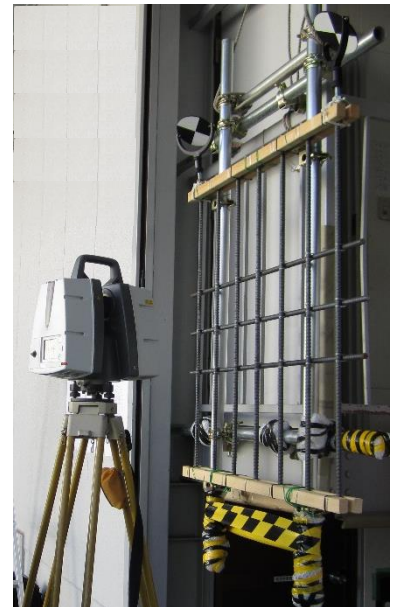
図-1 鉄筋組とスキャナ
