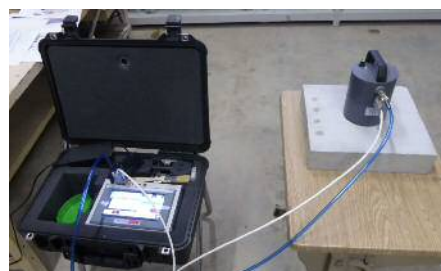
図 1 表層透気試験状況
