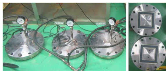
写真-1 止水試験状況とシール材貼付形状
