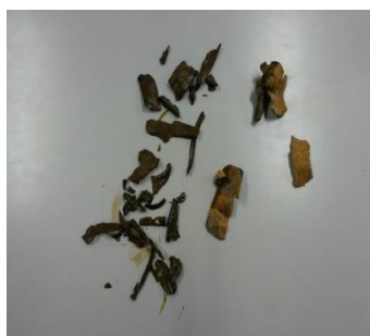
写真-2 排土に混入した切削片 写真-3 切削片寸法測定 (3) 振動・騒音
