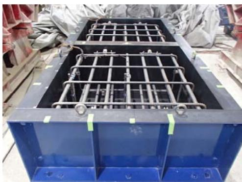
写真-1 熱電対設置状況
