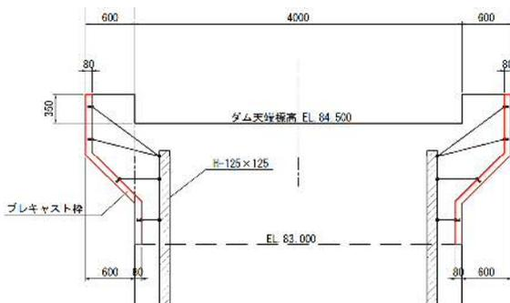
図-2 天端高欄張出し部施工
