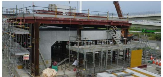
写真2 型枠脱型後の実験体全景
