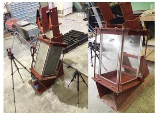
図-1 トンネル覆工模擬型枠
