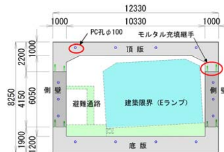
図-2 PCa 断面図
