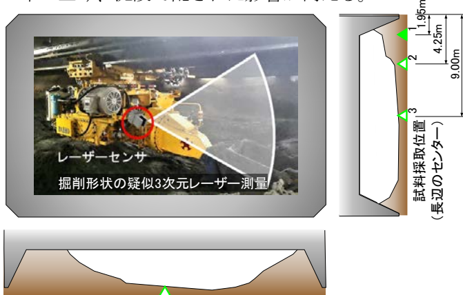
図-5 掘削面からの試料の採取位置
