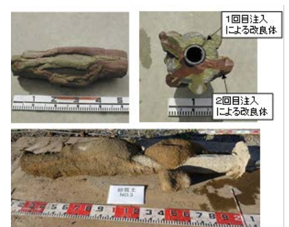
写真2 補強体径増加の概念図
