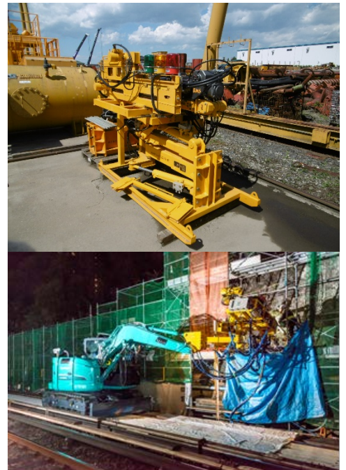
写真4 改良前後の削孔機
