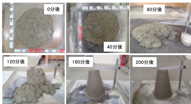
写真 2 静置スランブ試験状況 *数値は静置時間
