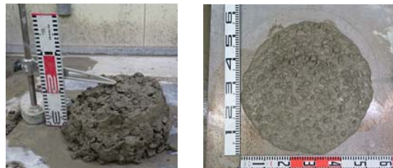
写真-1 従来覆工(左)と高流動コン(右)の外観
