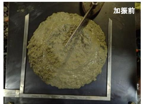
写真-1 T3-4(Ad)スランプ試験結果(筒先サンプリング)
