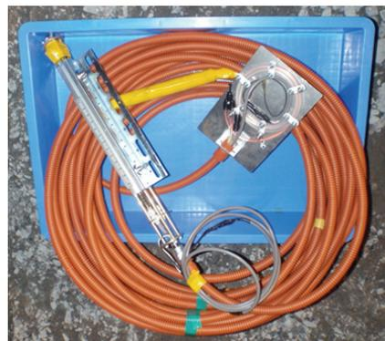
図-1 インバート変位計外観
