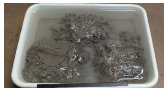
図-2 浸水崩壊度試験（判定 4）
