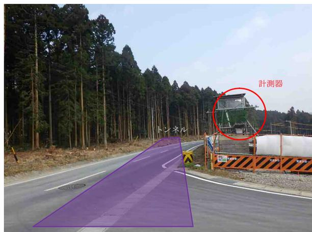
写真-2 市道部 地表面沈下計測状況
