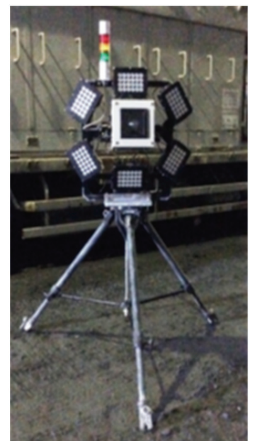
図-3 落石検知・警報装置 (照明付きカメラ)
