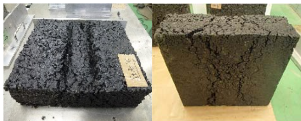
写真-6 (表層：高機能Ⅱ型、基層：ストアス)
