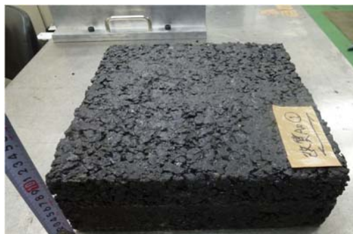
写真-4 供試体（表層：高機能Ⅱ型、基層：改質アス）
