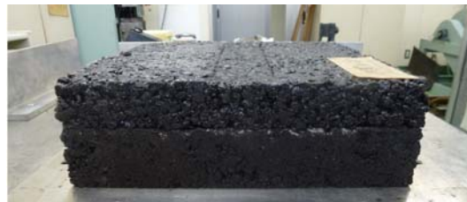
写真-7 (表層：高機能Ⅱ型、基層：改質アス)
