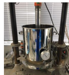
写真-1 水浸 CBR 試験の様子
