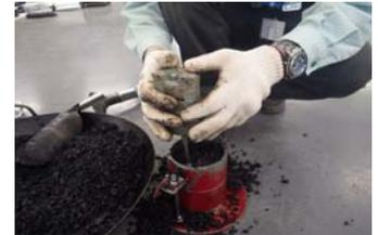
写真-3 貫入抵抗試験状況
