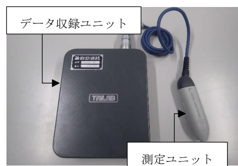
写真-1 3Dモーション摩擦測定機
