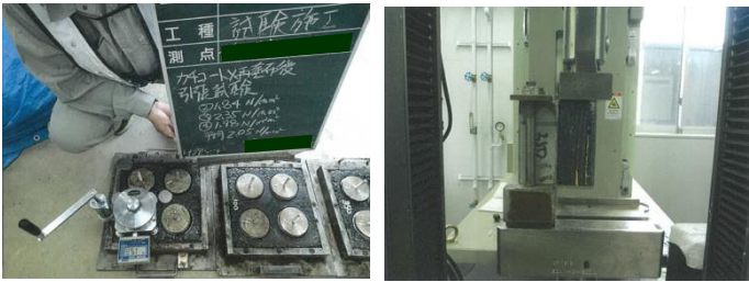
写真-2 試験状況（左：引張接着試験、右：せん断試験）
