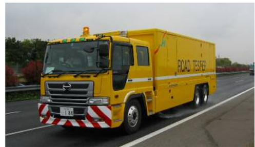
写真-1 大型すべり測定車
