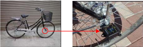
写真-1 加速度計の設置状況
