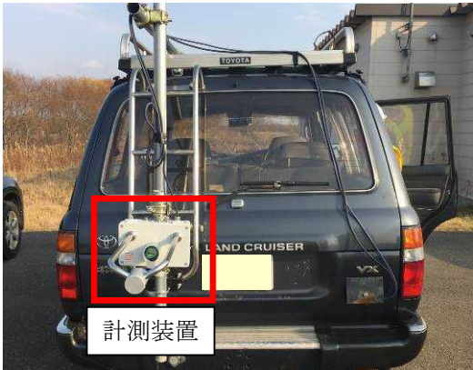
写真-1 車載型飛沫計測装置の設置状況
