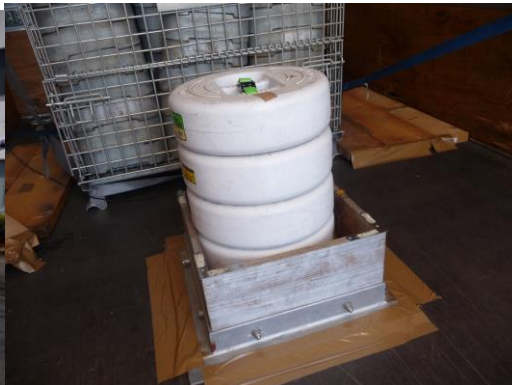
写真3 60kgf 錘とその下に荷重計
