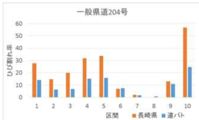
図 3 MCI と道パトのひび割れ率の比較
