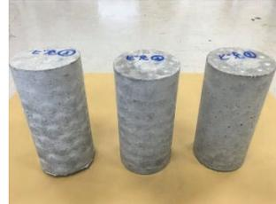
写真-2 ガラス玉充填供試体
