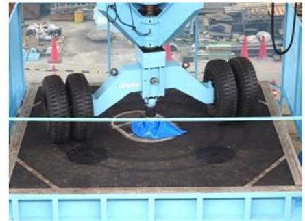
図3.輪荷重試験状況
