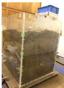
図-2 埋設管を設置した土槽
