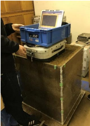
図-4 地中レーダによる探査
