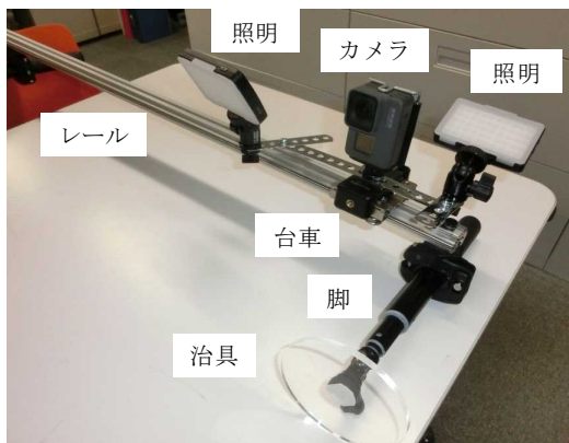
写真-2 撮影装置
