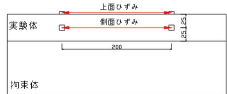
図-2 ひずみの測定位置(側面図)
