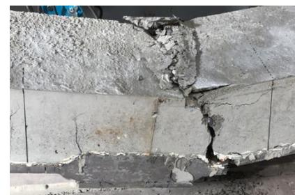
写真-5 No.4 供試体の破壊状況
