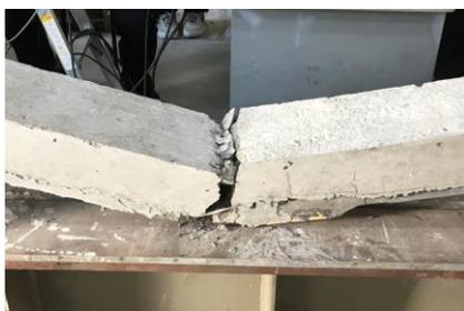
写真-4 No.1 供試体の破壊状況
