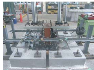
図4 定点疲労載荷試験
