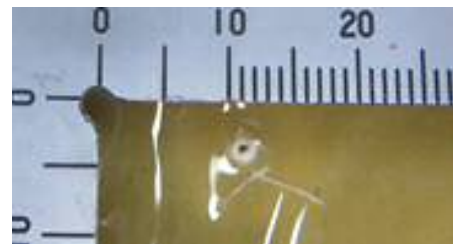
写真3 被覆表面の穴 (1.2mm) 周辺の状況 (case4)
