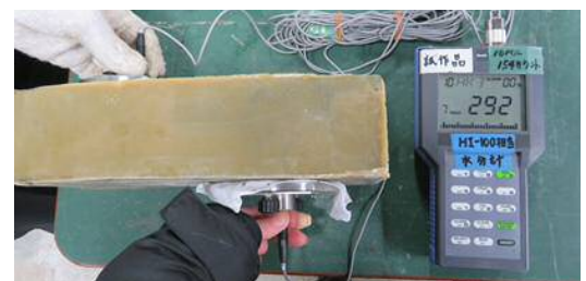
写真4 水分計を用いた絶縁性の確認状況 (case4)
