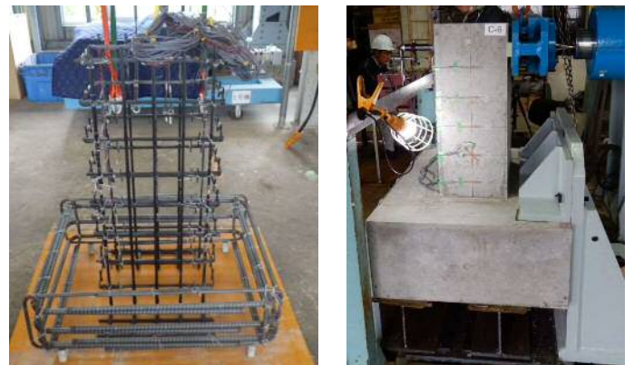
図-3 配筋および試験状況
