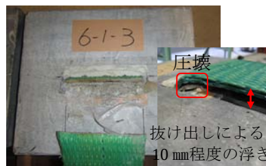
写真-4 破壊状況 (モルタル: 試験後アラミド FRP 切断)
