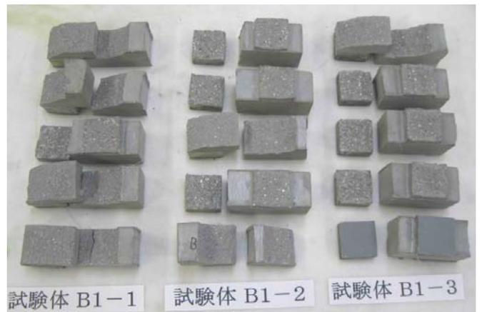
写真2 B1 試験体の破壊状況
