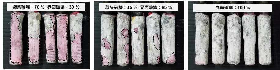
写真-2 接着系の破壊形態（左：ひび割れなし，中央：0.2mm，右：0.5mm）
