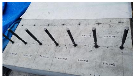
写真-1 ひび割れ試験用コンクリート
