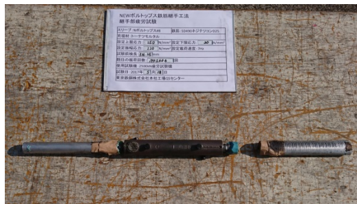
写真-2 試験体破断状況
