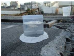
写真-5 吸水試験状況
